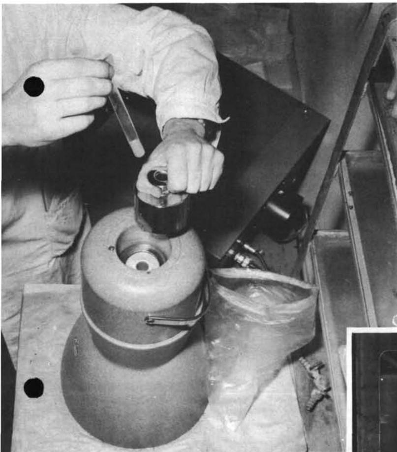
Izquierda: Introducción de una muestra en un contador de centelleo de cavidad. Gran parte de las radiaciones emitidas por la muestra incide en el cristal - que en la figura aparece como un anillo blanco dentro del fuerte blindaje de plomo - dando origen a pequeños destellos luminosos. El ritmo con que se producen esos destellos permite calcular la cantidad de sustancia radiactiva contenida en la muestra
