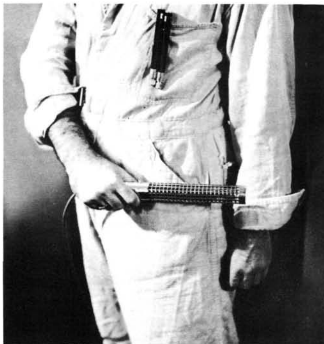
Un trabajador radiológico mide la actividad de su cuerpo y ropas con un instrumento manual
