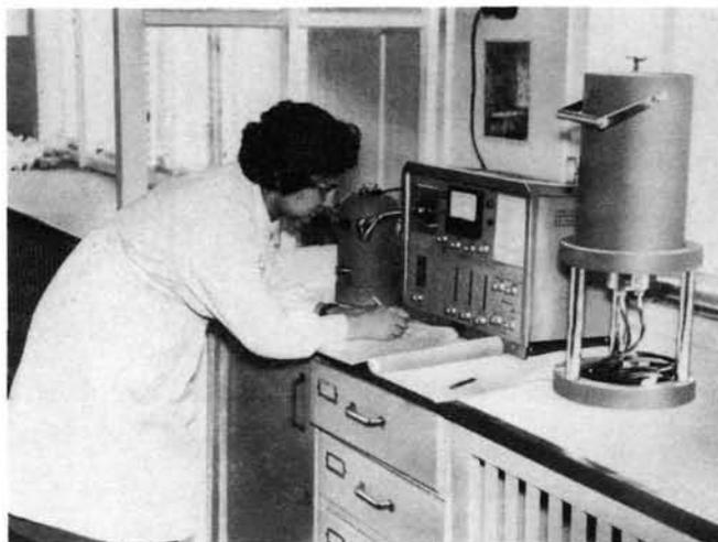
Una auxiliar de laboratorio lee en un escalímetro los valores de la radiactividad de las muestras colocadas en uno de los instrumentos detectores que se ven en la foto
