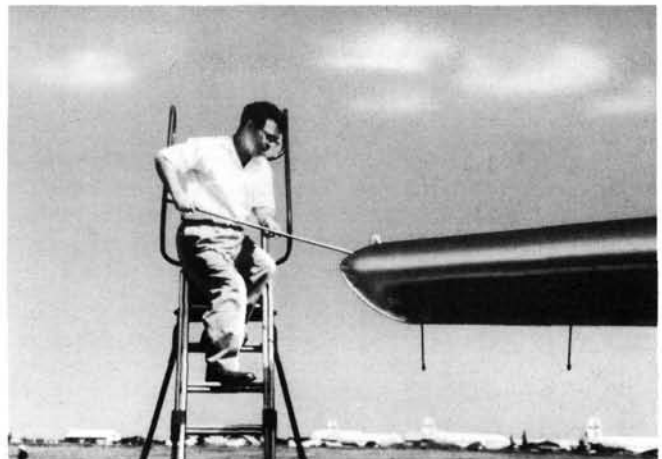
El Sr. J.D. Pearson, experto en asistencia técnica del OIEA, retirando un cargamento de sodio y potasio radiactivos del extremo del ala de un avión en el aeropuerto de Bangkok. Los radioisótopos se transportan en los extremos de las alas para que no haya peligro de irradiación de las personas que se encuentran a bordo de la aeronave. Los isótopos de ese cargamento fueron utilizados para ayudar a los médicos tailandeses a estudiar algunos casos de cólera
