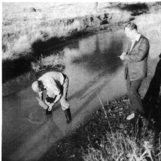
Prélèvement d'échantillons d'eau pour en déterminer la teneur en tritium, dans le cadre d'un projet de recherches sur les eaux souterraines financé par le Fonds spécial des Nations Unies en Grèce (Photo de la Commission de l'énergie atomique de la Grèce)
