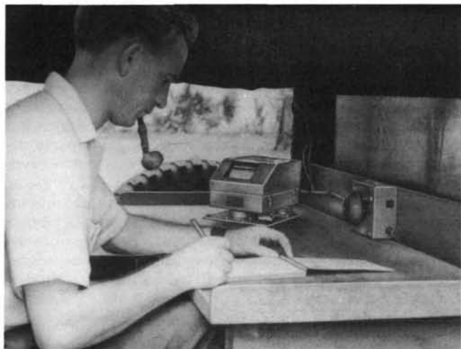
Experto del OIEA manejando el equipo de prospección autotransportado. Pueden verse el aparato registrador y el dispositivo de alarma montados en una mesa situada en la parte trasera del vehículo
