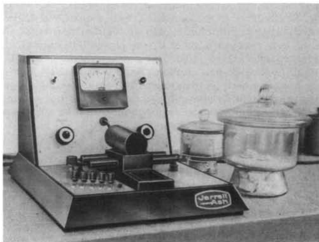
Fluorímetro proporcionado por el OIEA, instalado en el laboratorio. Este instrumento se utiliza para determinar el contenido de uranio por fluorescencia
