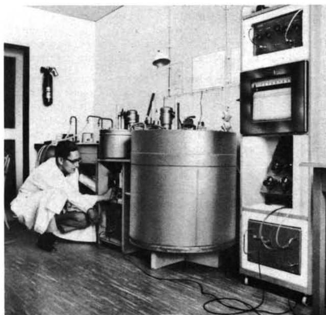
monde à assurer l'étalonnage des doses de rayonnement absorbées, par voie de mesures directes exprimées en unités physiques fondamentales. On installera aussi dans le laboratoire des appareils pour la comparaison et l'étalonnage d'autres instruments de mesure de la dose absorbée. Par la suite, on installera une source complète de cobalt-60 pour l'émission d'un faisceau permettant l'étalonnage d'appareils de mesure des rayonnements en fonction d'un étalon de dose absorbée.
