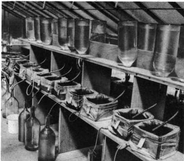
Etude en serre, au moyen du phosphore-32, de l'effet du mouvement de l'eau sur la fixation du phosphate par des plants de riz
