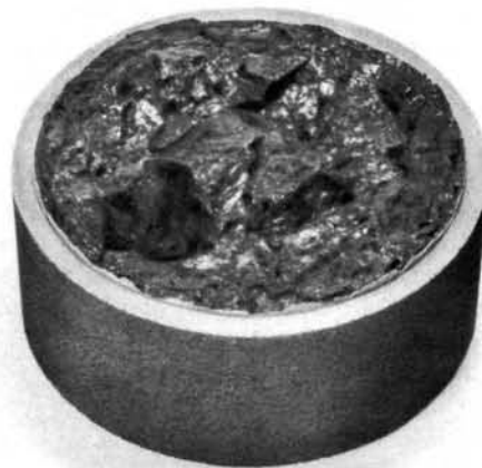
Aspecto de una masa vítrea que contiene desechos radiactivos (fotografía tomada de la memoria presentada por M.N. Elliot, R. Gayler, J.R. Grover y W.H. Hardwick)
