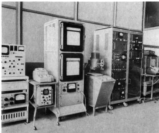
Espectrómetros multicanal para mediciones de rayos alfa y gamma, del Centro nuclear de Fontenay-aux-Roses (Francia)
