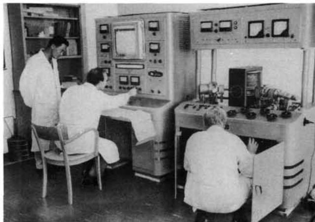
El espectrómetro de masas del laboratorio de Seibersdorf se utiliza para determinar el nitrógeno-15 contenido en algunos vegetales abonados con fertilizantes enriquecidos en este isótopo estable
