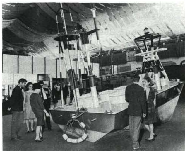
Exposición en el Plainpalais de Ginebra. Estación meteorológica flotante que funciona con energía de origen nuclear, expuesta en la sección de los Estados Unidos y destinada a transmitir informes. Un generador nuclear SNAP-7 le proporciona la energía eléctrica necesaria (Foto USAEC)
