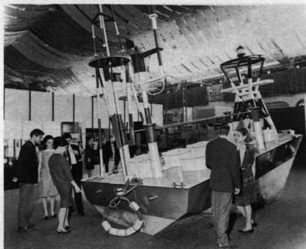
L'exposition à Plainpalais (Genève). Les Etats-Unis exposent une station météorologique atomique flottante, destinée à transmettre des rapports. La station est alimentée en électricité par une génératrice nucléaire Snap-7 (Photo CEA-EU)
