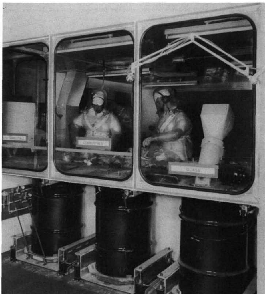
Triage des déchets radioactifs à l'intérieur d'une zone hermétiquement close. Les hommes portent des vêtements pressurisés. (Extrait d'un mémoire présenté par R.H. Burns et coll.)
