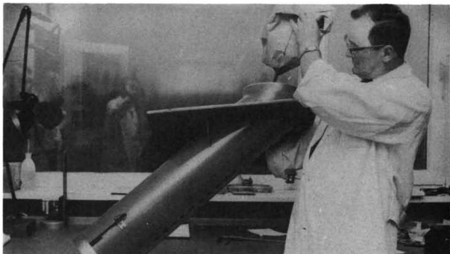
Una vez esterilizadas, las ninfas se meten en bolsas de papel donde se conservan hasta que se transforman en moscas. A bordo del avión las bolsas se introducen en el tubo de dispersión; con este sistema se puede llegar a dispersar el contenido de una bolsa cada dos o tres segundos.
