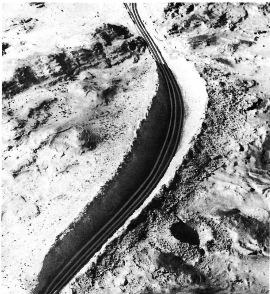
Ouverture d'un col en montagne, à l'aide d'explosifs nucléaires, pour le passage d'une ligne de chemin de fer et d'une route, sur la base d'une étude technique réalisée aux Etats-Unis.
