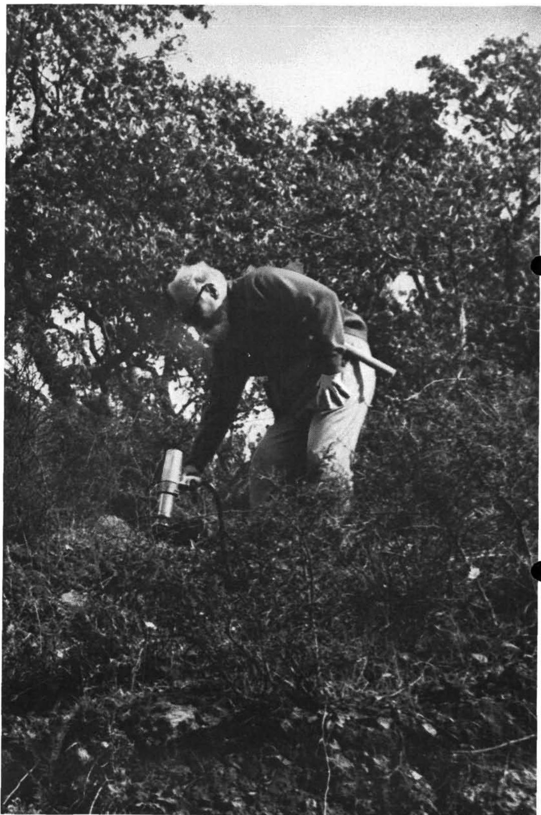
Un experto del OIEA en Túnez utiliza equipo portátil para la prospección de yacimientos de minerales radiactivos.
