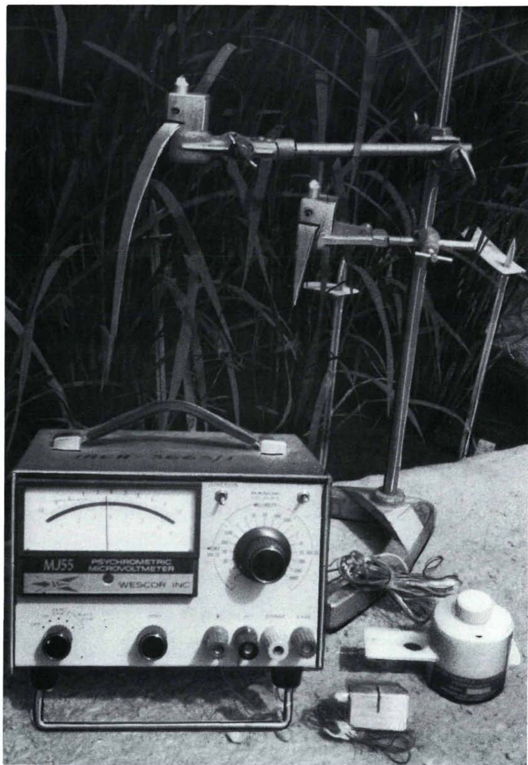
Un psychromètre fonctionnant sur la feuille d'une plante et dans le sol.
