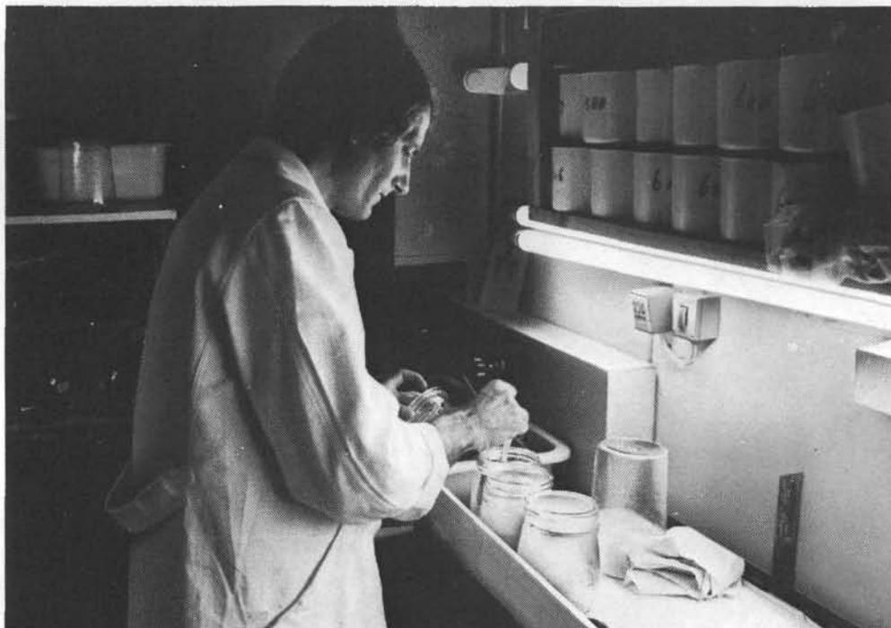
En esta dependencia del Laboratorio, en la que se mantiene constante la temperatura ambiente, los organismos marinos empleados en experimentos (camarones, almejas, cangrejos, etc.) son objeto de diversos ensayos empleando trazadores radiactivos. El agua de mar que llega a los grifos procede del sistema de alimentación del Museo Oceanográfico, importante instalación entre aquellas de que dispone el Laboratorio.
