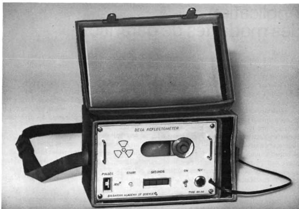
Ce réflectomètre bêta portatif permet à l'inspecteur des garanties de déterminer la fraction d'uranium ou de plutonium contenue dans des échantillons de poudre ou de pastilles de combustible. Il a été mis au point par l'Académie des sciences bulgare sous contrat de l'AIEA.
