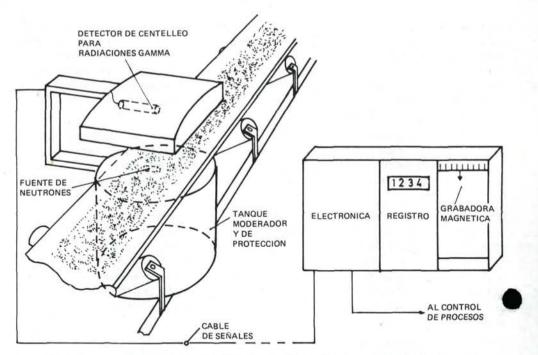
La medición de las radiaciones gamma inducidas por captura neutrónica suministra un medio de determinación del contenido de hierro de los concentrados de mineral durante su transporte.
