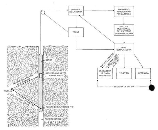
Método de sondeo del contenido metálico de los yacimientos de níquel o de cobre por detección de las emisiones gamma instantáneas inducidas por captura neutrónica. Una fuente de neutrones se introduce en un pozo de sondeo y se miden con un centelleador las emisiones gamma. Estas técnicas nucleares permiten la caracterización de muestras más grandes y más representativas que las obtenidas generalmente mediante las técnicas tradicionales de extracción.
