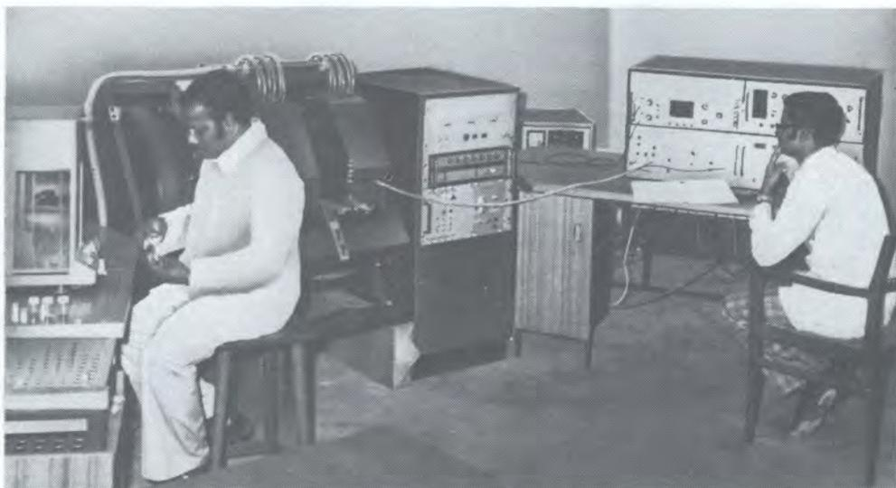
Анализ содержания масла в семенах масличных культур проводится в институте с помощью прибора, основанного на действии ядерного магнитного резонанса (ЯМР).
