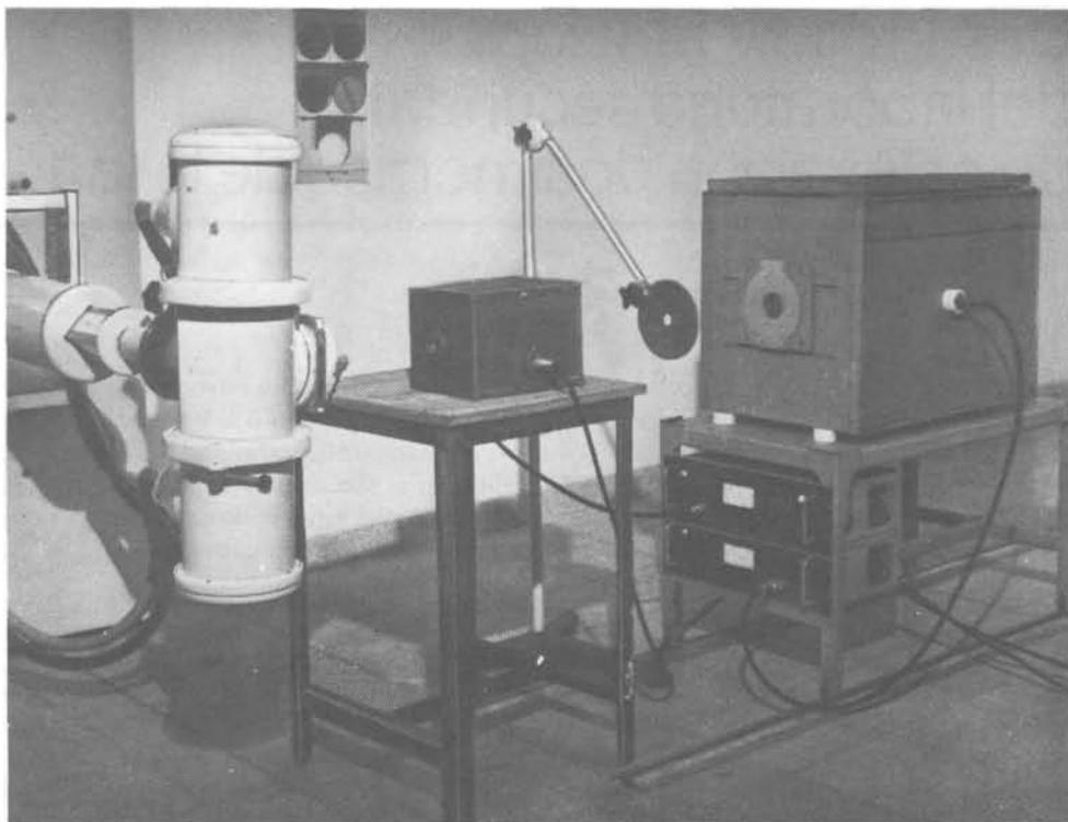
Foto 1: Cámara de aire libre, de placas paralelas, empleada como patrón primario para rayos X de hasta 300 kV.
