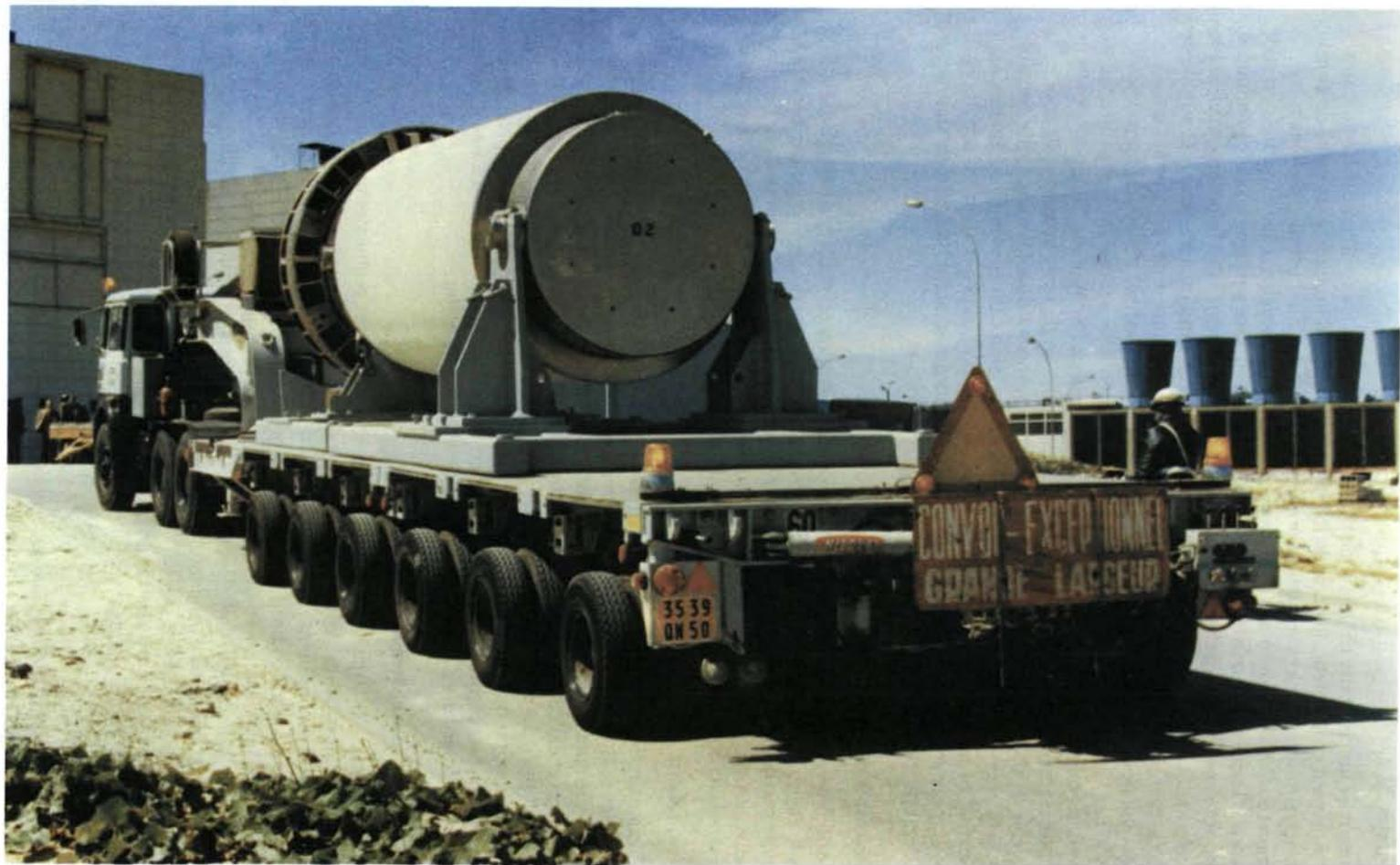
Photo 1. Château de transport NTL 11 de 75 tonnes monté sur un véhicule routier.
