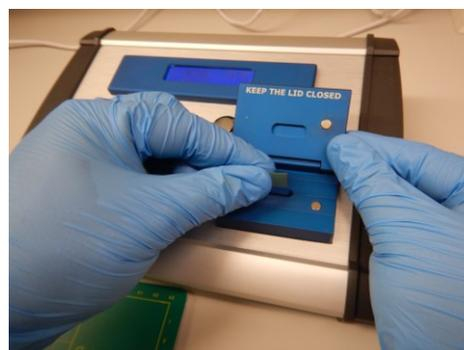
Figura 8. Insertando la película Gafchromic en el DR4. La película debe ser manejada con guantes o pinzas.
