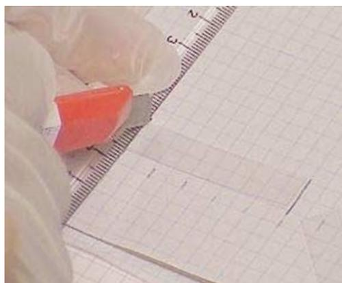
Figura 13. Una navaja afilada, una regla de plástico y una cuadrícula debajo de la película ayudan a cortarla convenientemente al tamaño deseado.
