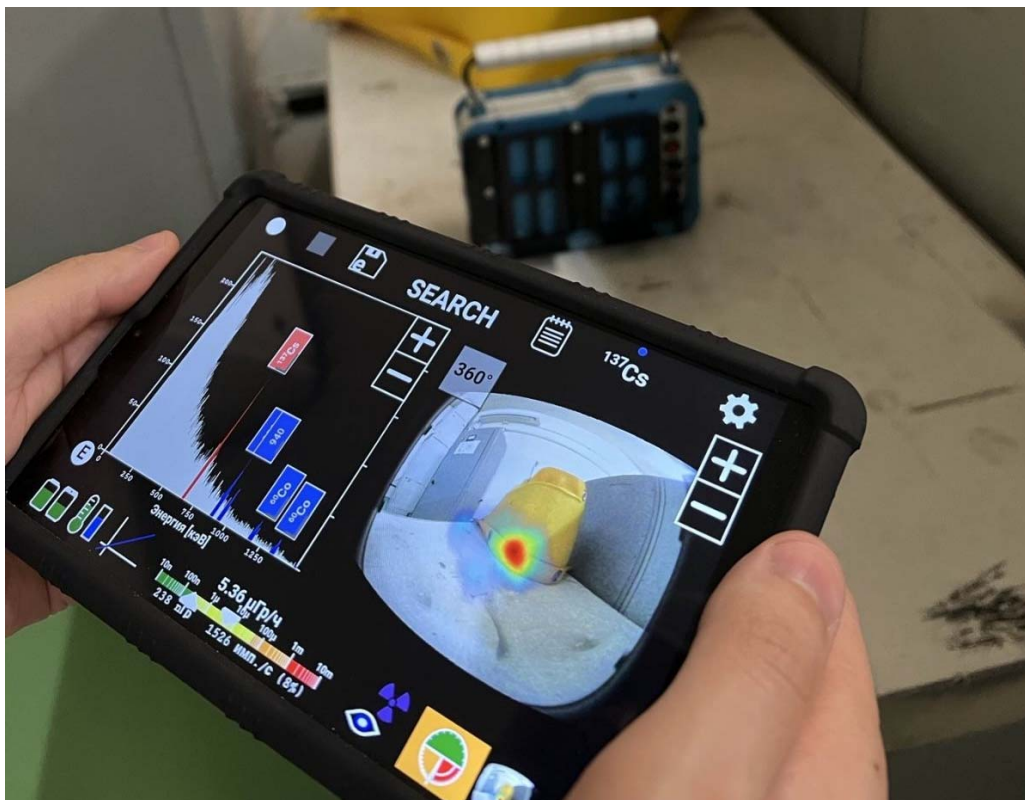
Spectromètre gamma utilisé à la centrale nucléaire d'Ukraine du Sud. Cet appareil a été acheté par l'Agence à l'aide d'une contribution extrabudgétaire du Royaume-Uni et livré à la centrale nucléaire d'Ukraine du Sud le 26 mai 2023. (Photo : centrale nucléaire d'Ukraine du Sud)
