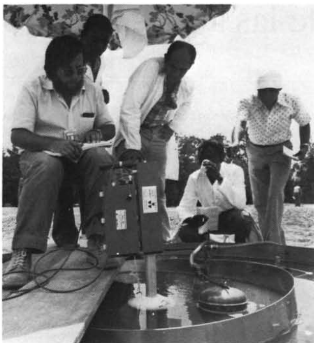
Jóvenes ingenieros de Israel, Costa de Marfil, Yugoslavia, Mauricio e India estudian con un higrómetro neutrónico la infiltración del agua en el suelo, durante un curso de capacitación organizado por la FAO y el OIEA en Cadarache, Francia.
