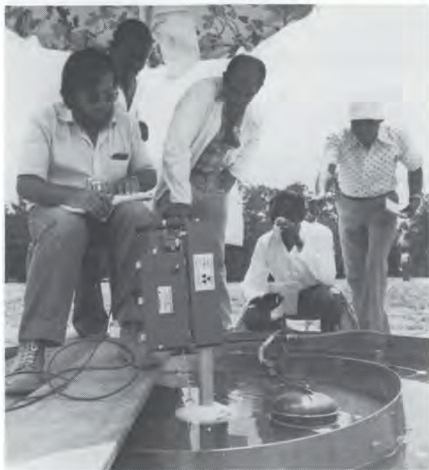
На учебных курсах ФАО/МАГАТЭ в Кадараше, Франция, молодые инженеры из Израиля, Берега Слоновой Кости, Югославии, Маврикия и Индии изучают инфильтрацию воды в почву с помощью нейтронного влагомера.
