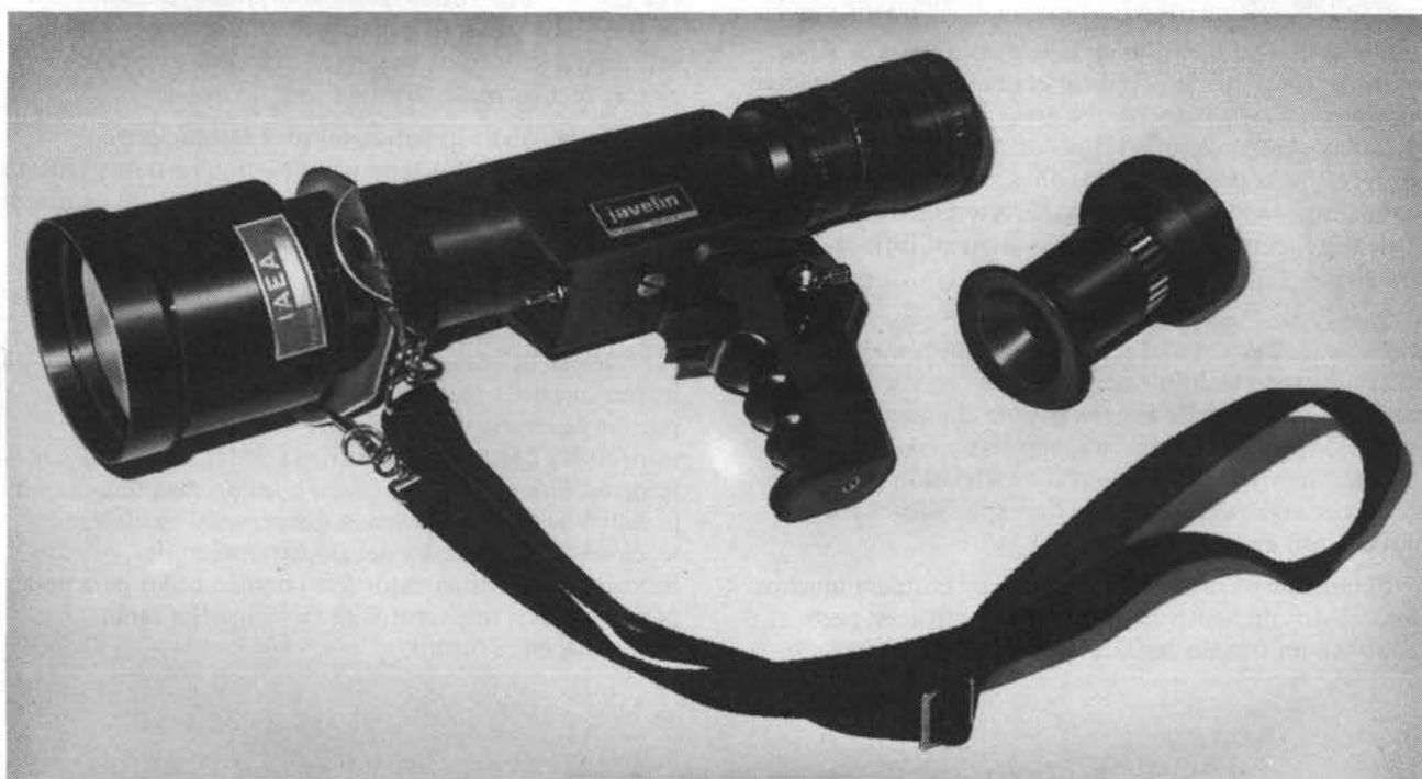
Figura 8. Dispositivo de visión nocturna que puede utilizarse para detectar la radiación de Cerenkov emitida por el combustible agotado almacenado en piscinas de enfriamiento.
