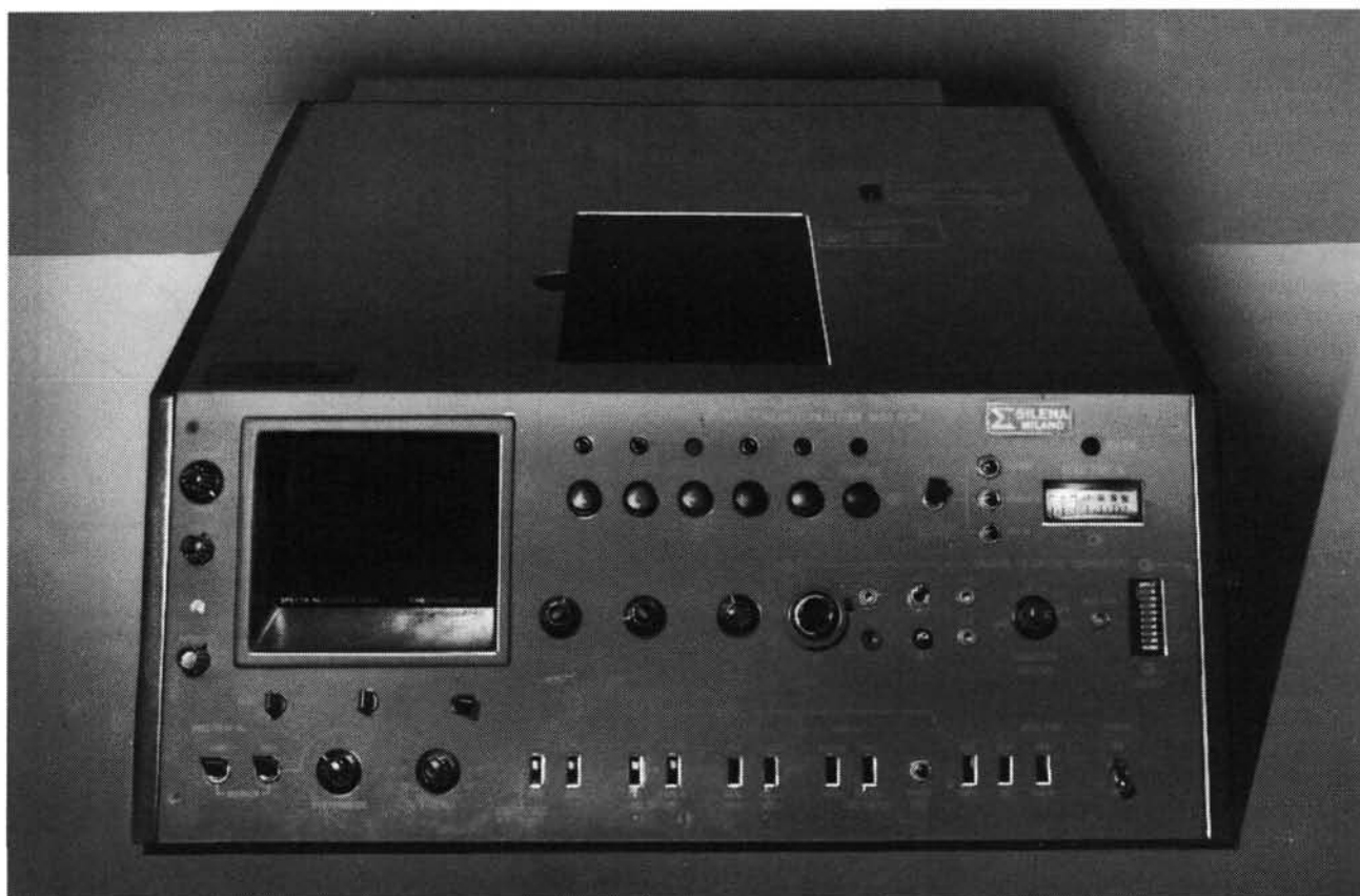
Figure 6. Silena, spectromètre gamma portable à 1024 canaux.
