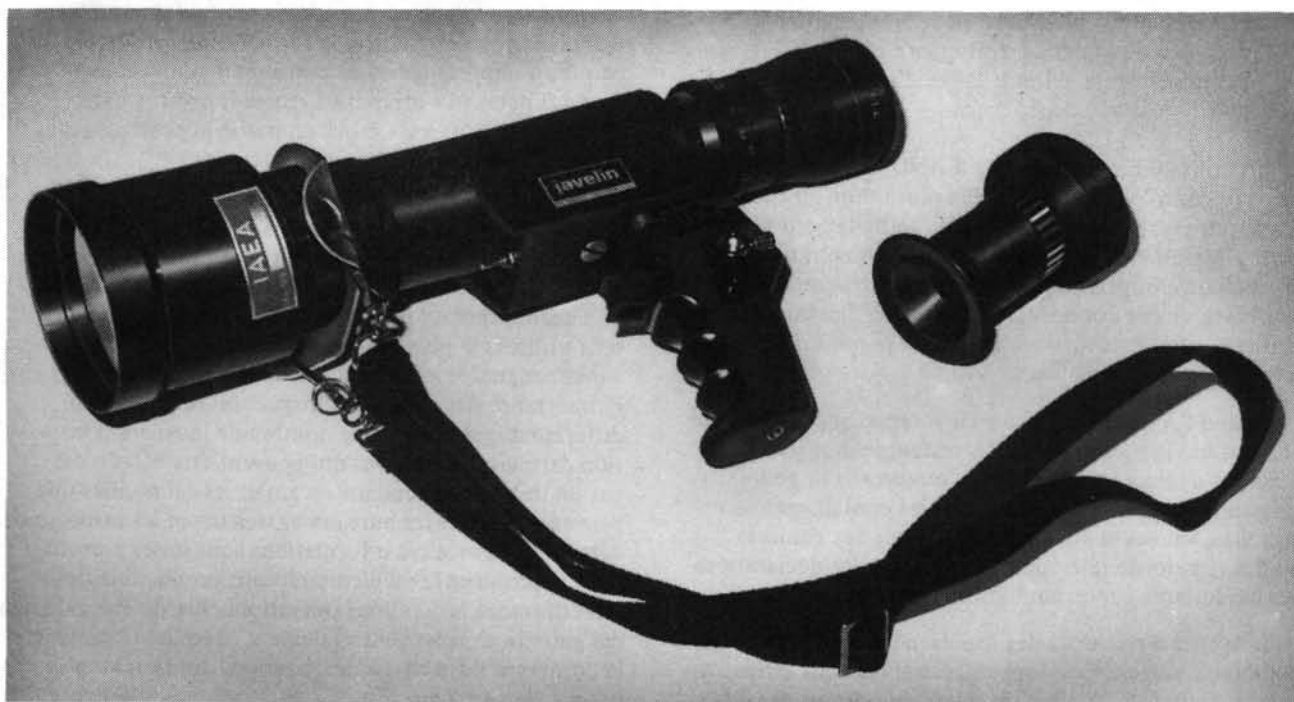
Figure 8. Système d'observation nocturne pouvant être utilisé pour détecter le rayonnement de Tcherenkov émis par le combustible irradié dans les piscines de désactivation.
