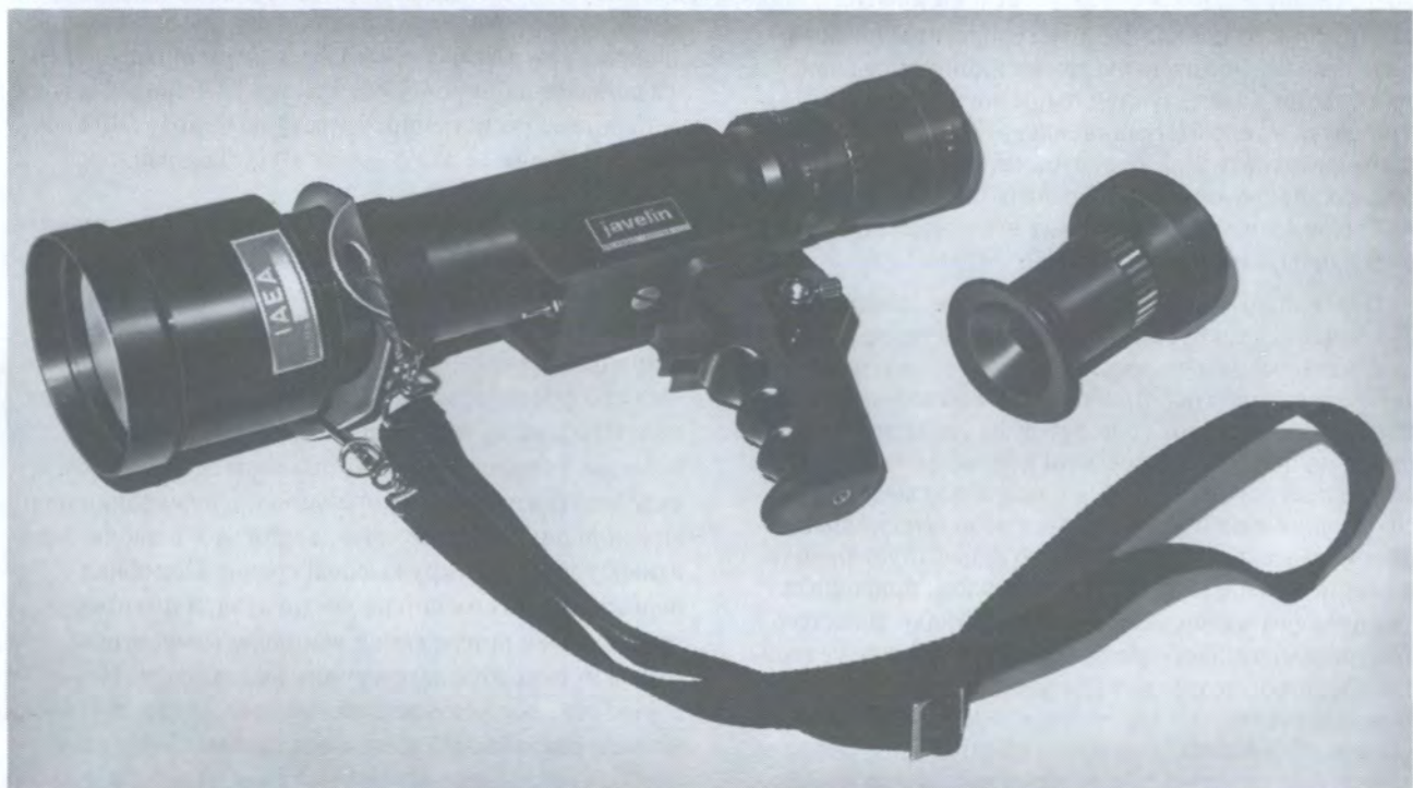
Рис. 8. Прибор ночного видения, который можно использовать для регистрации черенковского излучения, испускаемого отработавшим топливом, которое находится в бассейнах выдержки.
