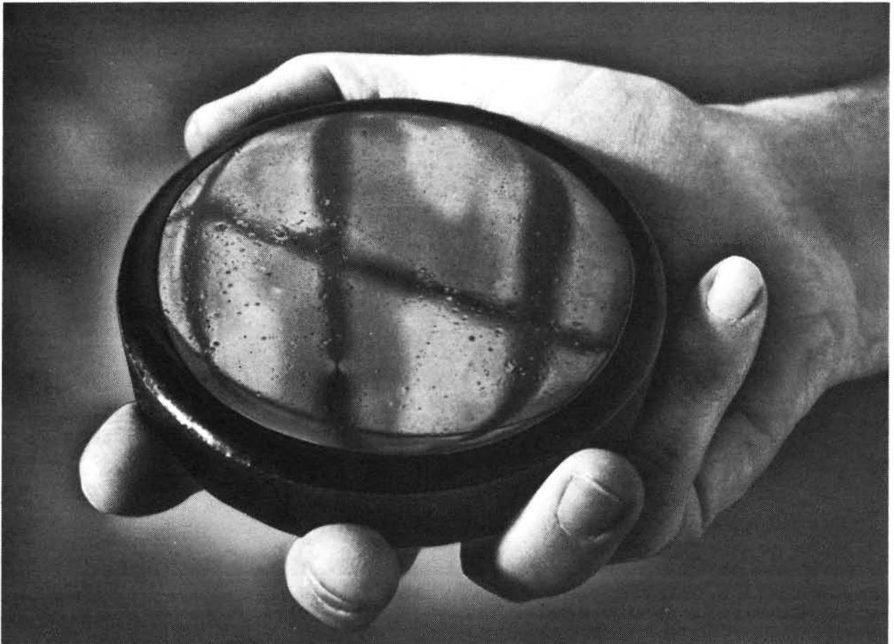
Modelo de desecho radiactivo vitrificado. Si toda la electricidad utilizada por una persona a lo largo de su vida fuese producida mediante la energía nuclear este volumen de vidrio sería suficiente para obtener todos los desechos de alto nivel resultantes.
