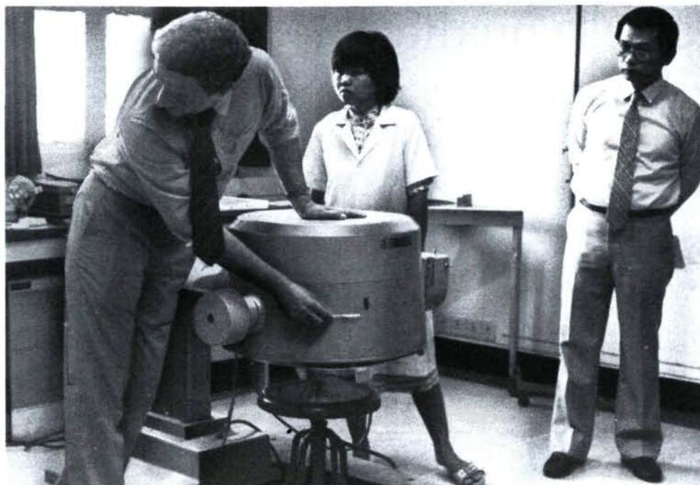
Pendant le séminaire de Bangkok, un expert de l'Agence se sert d'une petite source de  $^{99m}\text{Tc}$ , pour montrer comment dépister les défauts d'étanchéité du blindage d'une caméra gamma.
