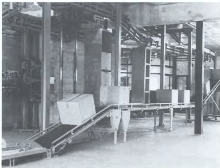
Установка по стерилизации медицинских инструментов и средств с использованием радиоактивного \text{Co-60} , построенная в Югославии с помощью МАГАТЭ и ПРООН. Экран и конвейер рассчитаны на максимальную загрузку 1 МКи \text{Co-60} .
