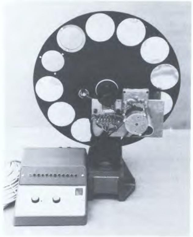
Автоматический круг для быстрой установки фильтров, необходимых при определении чистоты рентгеновского излучения.
