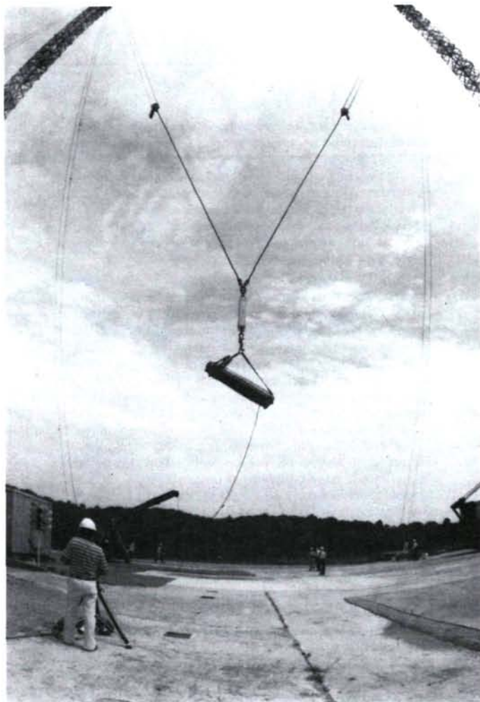
Choques, fuegos y caídas peores que los que ocurren en condiciones reales de transporte: estos son algunos de los implacables ensayos que han soportado los cofres de combustible agotado sin detrimento esencial de la contención ni reducciones importantes en el blindaje. (Cortesía de Atomic Industrial Forum, Inc.)
