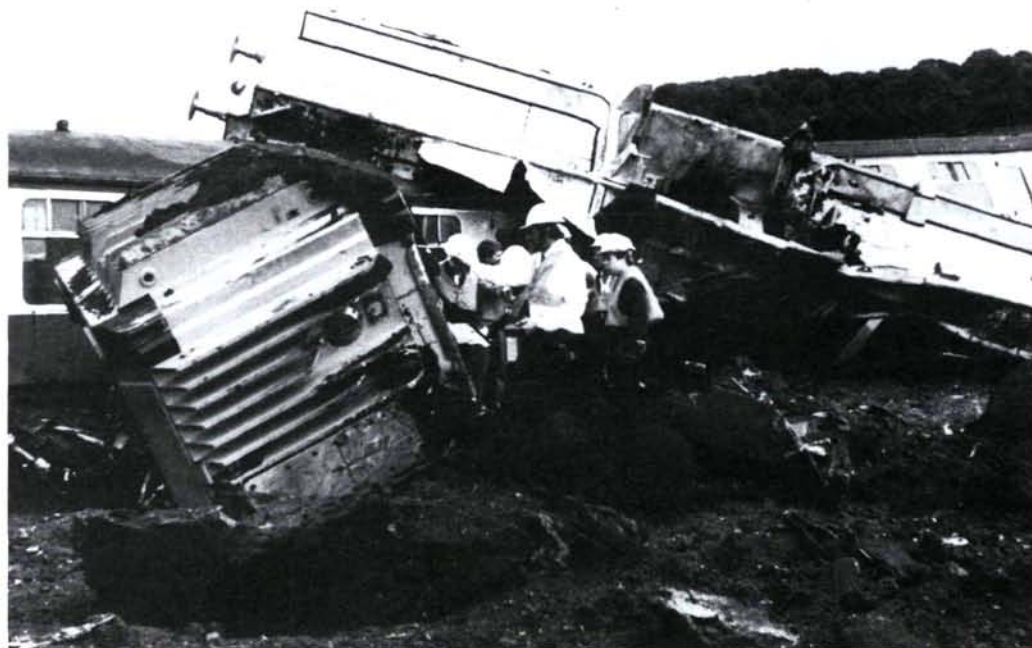
El paciente sobrevivió. Para demostrar públicamente la integridad estructural de los cofres de expedición, en julio de 1984 la Central Electricity Generating Board (CEGB) del Reino Unido realizó un ensayo valorado en 2,1 millones de dólares EE.UU. Una locomotora diesel de 140 toneladas que tiraba tres coches de 35 toneladas y se desplazaba a unos 160 kilómetros por hora se proyectó de frente contra un cofre de expedición. Pese a que el impacto lo lanzó a 60 metros, el cofre sólo sufrió algunos rasguños y protegió cabalmente su contenido, consistente en desechos nucleares simulados que no resultaron afectados. El tren quedó totalmente destruido. (Cortesía de la CEGB)
