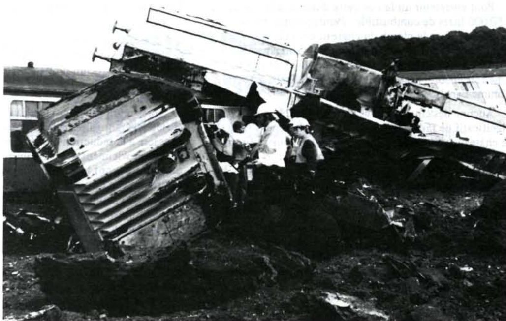
Le sujet a survécu: Pour faire au public la démonstration de l'intégrité structurale des châteaux de transport, le Central Electricity Generating Board du Royaume-Uni a procédé, en juillet 1984, à un essai qui a coûté 2,1 millions de dollars — le château de transport a été heurté de plein fouet par une locomotive diesel de 140 tonnes remorquant trois voitures de 35 tonnes et lancée à 160 kilomètres à l'heure. Sous l'effet du choc, le château de transport a été projeté à une soixantaine de mètres et n'a cependant subi que quelques éraflures, sans rien laisser échapper de son contenu — des déchets nucléaires simulés — resté indemne. Le train était détruit. (Photo Central Electricity Generating Board)
