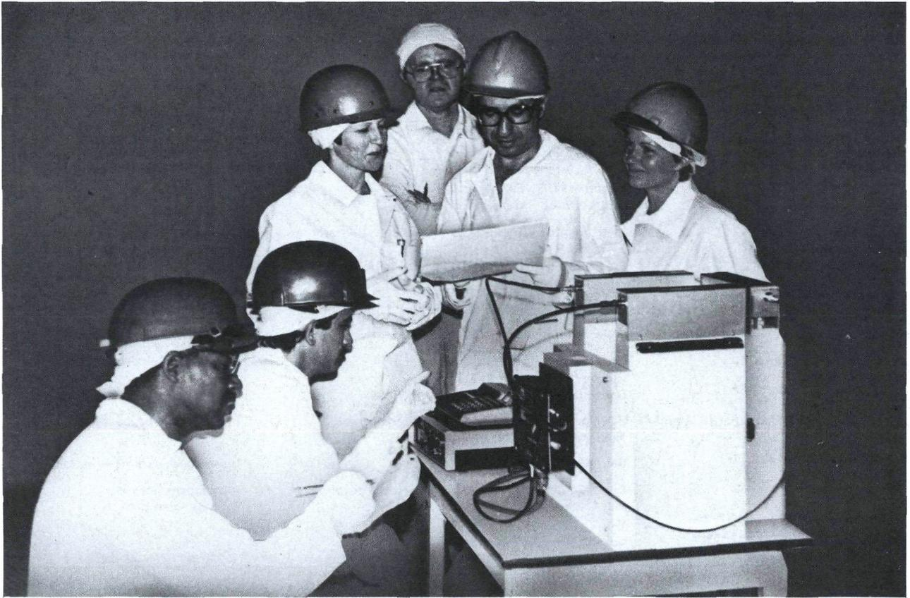
Funcionarios e inspectores nuevos del OIEA montan el collar de coincidencias neutrónicas para el uranio y prueban su funcionamiento. El equipo se utiliza para medir el contenido de uranio en el combustible fresco de los reactores de agua ligera.
