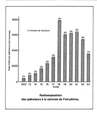
Radioexposition. Divers types de robots ont contribué à réduire la radioexposition du personnel chargé des inspections. Comme le montre le graphique ci-joint, on y est parvenu à la centrale de Fukushima depuis l'installation, en 1978, de divers systèmes robotiques, alors que de 1972 à 1978 l'exposition aux rayonnements avait augmenté.
