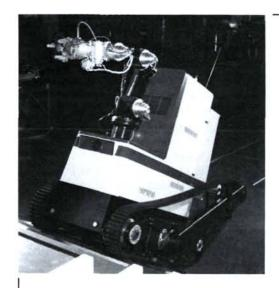
Ces robots universels ont été réalisés par des entre-prises japonaises pour l'inspection et la maintenance dans les centrales nucléaires. «Amooty» a été conçu par Toshiba, le tout-terrain par Hitachi et le robot à un bras par Mitsubishi. (Photos: PNC)
