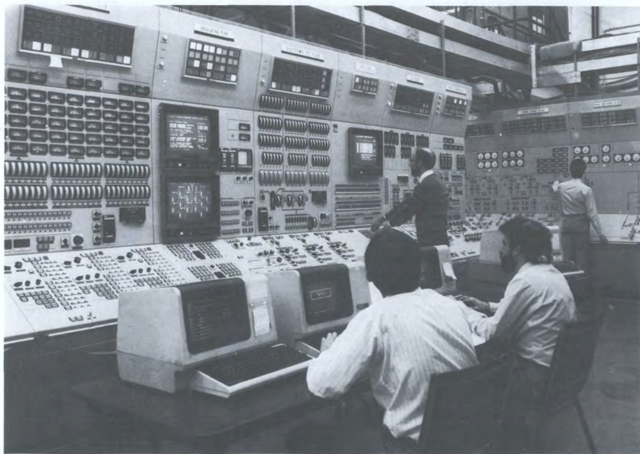
Тренажеры представляют собой подлинные модели конкретного блочного щита управления. На фото показаны системы для АЭС Саскуэханна, США (вверху) и для АЭС Брюс-Б с реакторами типа КАНДУ фирмы Онтарิโอ хайдро, Канада. (Предоставлены: верхнее фото — Link SSD; нижнее фото — CAE Electronics Ltd.)
