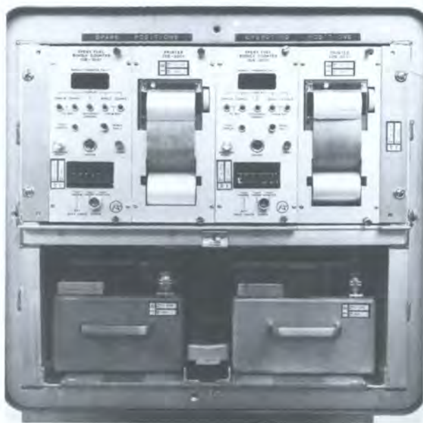
Счетчик отработавших сборок был разработан для реакторов КАНДУ с перегрузкой на мощности. (Фото AECL)
