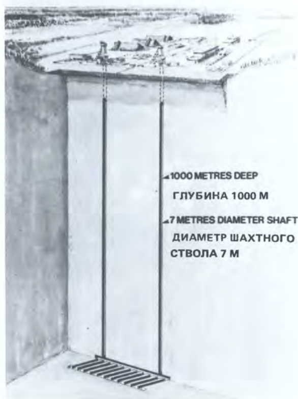
Одна из концепций захоронения отработавшего топлива. Шахтный ствол глубиной 1000 м и диаметром 7 м. (Источник: Министерство энергетики США).
