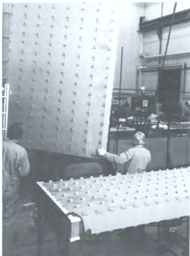
Производство стеллажей для хранения отработавшего топлива в Дании. (Фото RDM).
