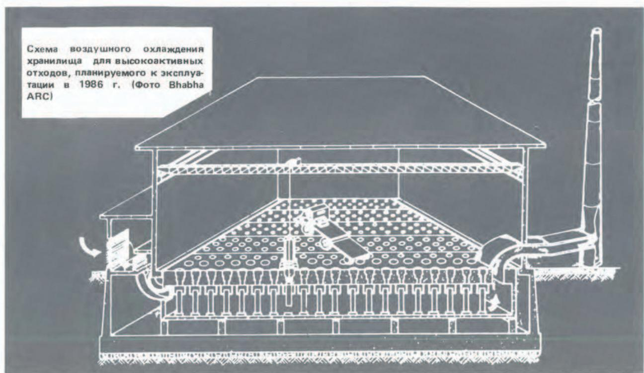
Схема воздушного охлаждения хранилища для высокоактивных отходов, планируемого к эксплуатации в 1986 г. (Фото Bhabha ARC)
