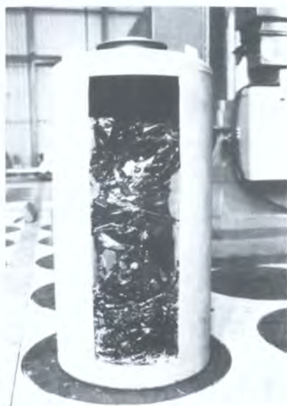
Макет контейнера с остеклованными отходами в зале хранилища завода по остекловыванию отходов AVM в Маркуле.
