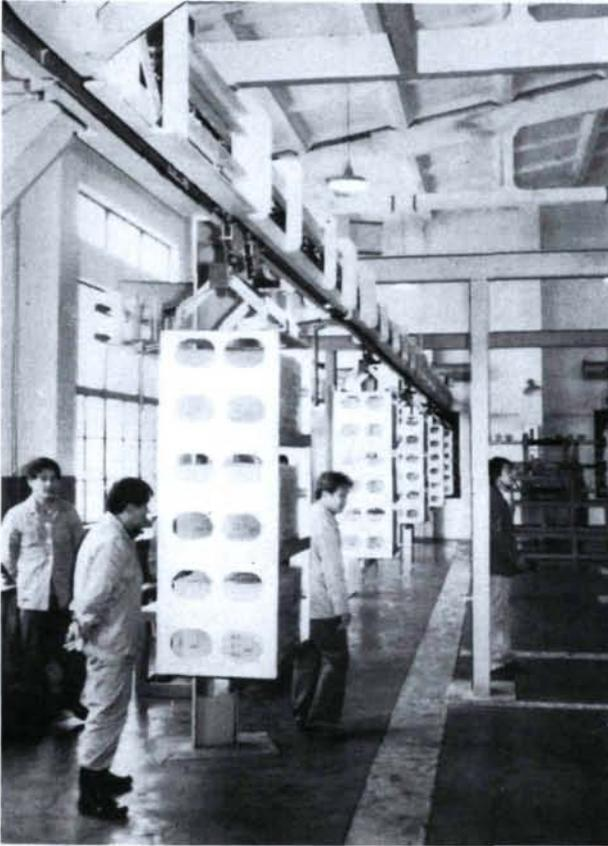
Caisnes de pommes transportées par convoyeur vers l'irradiateur de l'installation de Shanghai. (Photo: Wedekind)
