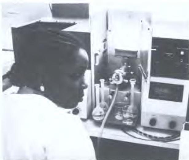
Проверка загрязненности тяжелыми металлами проб дождевой воды. (Фото Дж. Даглиш, МАГАТЭ).
