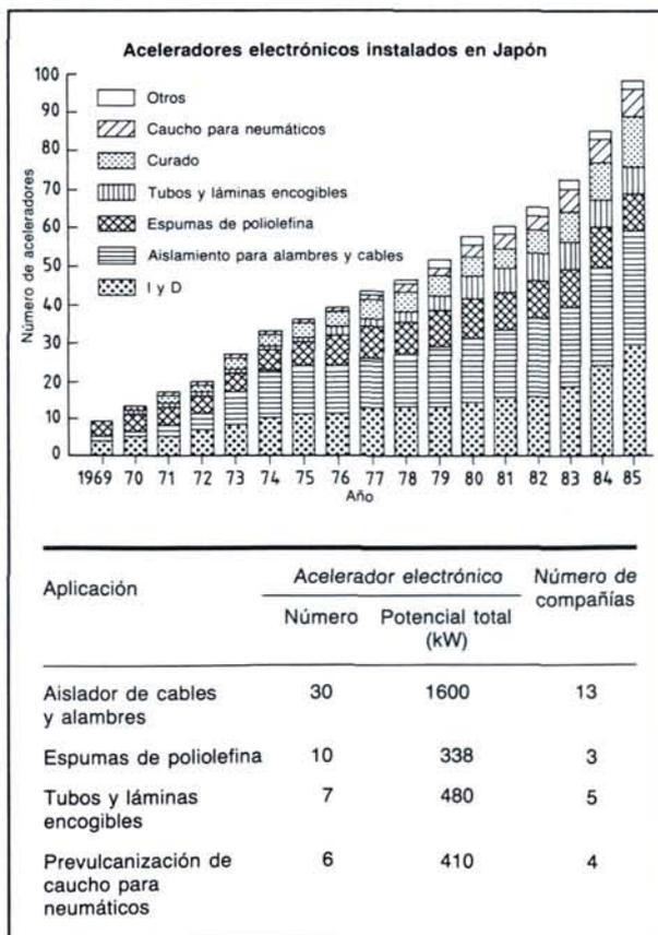
cables y alambres, materiales termoencogibles, tubos de polietileno para agua caliente, espuma, etc.); la radiovulcanización del caucho y la modificación de masas de polímeros (degradación controlada).
