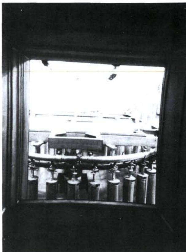
Dentro de la cámara de irradiación se somete a las crisálidas a la radiación gamma de cobalto 60 durante 10 minutos aproximadamente para su esterilización.
