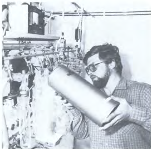
Установка для получения трития в виде газа используется для аналитических работ по изотопной гидрологии в лаборатории в Вене. (Фото Католики для МАГАТЭ).
