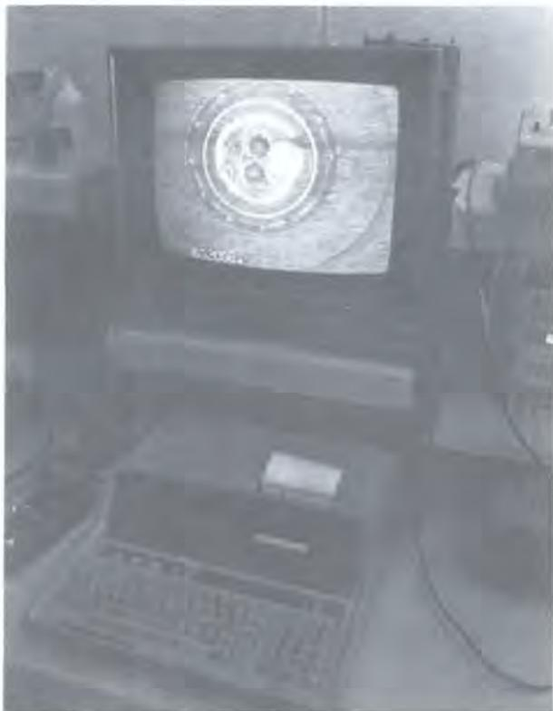
Металлические охранные печати обычно применяются инспекторами МАГАТЭ при перевозке или хранении ядерных материалов и затем проверяются на электронных приборах в штаб-квартире МАГАТЭ.
