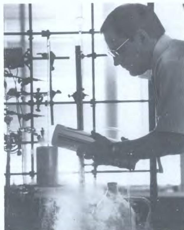
丰度。若示踪研究需要，每种元素都可以被浓缩到较重同位素所占比例达到99%甚至更高。利用它们在交换过程（例如氘）或低温蒸馏过程（例如一氧化碳或氧化亚氮）中速率的微小差别，除去较轻同位素，使较重同位素得到浓缩。浓缩后的物质，有的（例如 $^2\text{H}_2\text{O}$ 或 $\text{H}_2^{18}\text{O}$ ）可以直接利用， $^{13}\text{CO}_2$ 可以借助生物合成操作进入植物，有的同位素则可以通过有机合成制成标记脂肪、标记碳水化合物或标记氨基酸。
